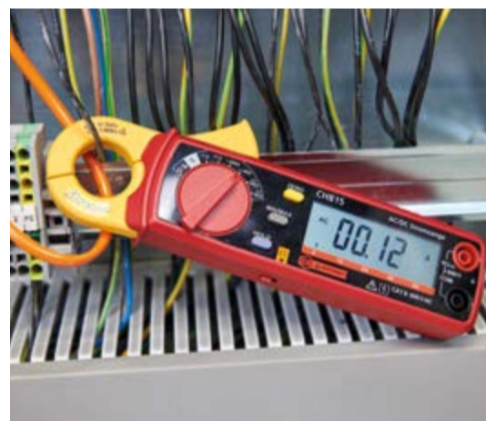
Strommesszange im Einsatz
